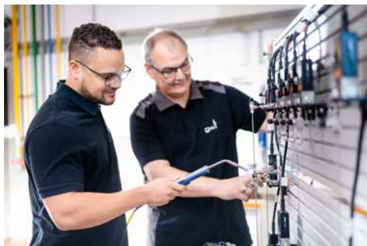
ABBILDUNG 21: ANLAGE ZUR ÜBERPRÜFUNG DER DICHTHEIT
