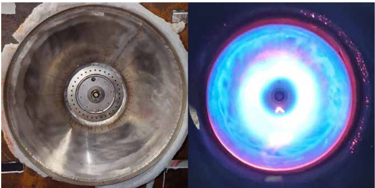
ABBILDUNG 43: ENTWICKELTES MEHRSTOFFBRENNERSYSTEM (LINKS) IM 100-kW-BETRIEB MIT SYNTHESSEGAS (RECHTS).
