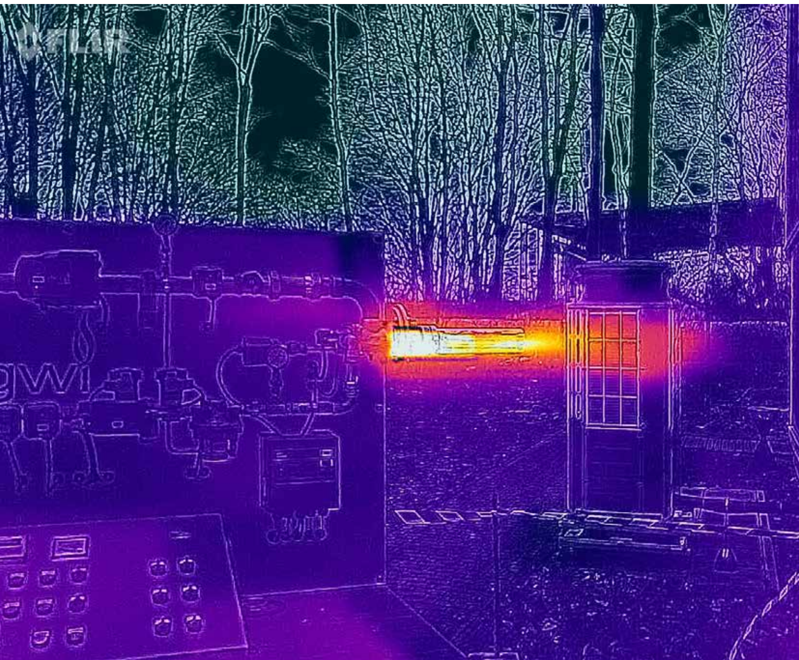
ABBILDUNG 11: WÄRMEBILD EINER WASSERSTOFFFLAMME
