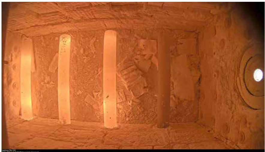
ABBILDUNG 44: AUFNAHME DES HOCHTEMPERATUROFENS; BETRIEB DES NEU ENTWICKELTEN BRENNERS BEI 0,1 % LAST, QUELLE: GWI
