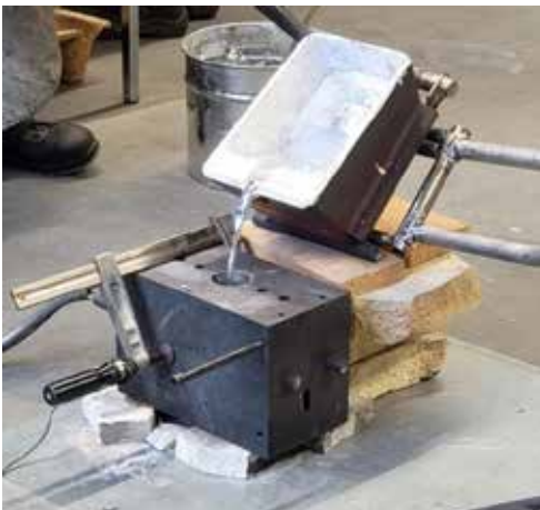
ABBILDUNG 41: GIESSEN DES GESCHMOLZENEN ALUMINIUMS IN DIE FORM (RECHTS) UND DAS ENTSTANDENE GUSSTEIL (LINKS)
