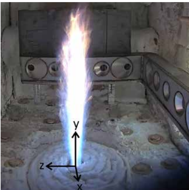
ABBILDUNG 47: ERPROBUNG DER KAMERASONDE MIT 10 SENSOREN AN EINER 100 kW ERDGAS-LUFT-FLAMME IM GWI-VERSUCHSOFFEN (LINKS, BLICK VON OBEN) UND INSTANTANE TOMOGRAPHISCHE 3D-REKONSTRUKTION DER FLAMMENFRONT, DARGESTELLT DURCH EINE ISOFLÄCHE (RECHTS).
