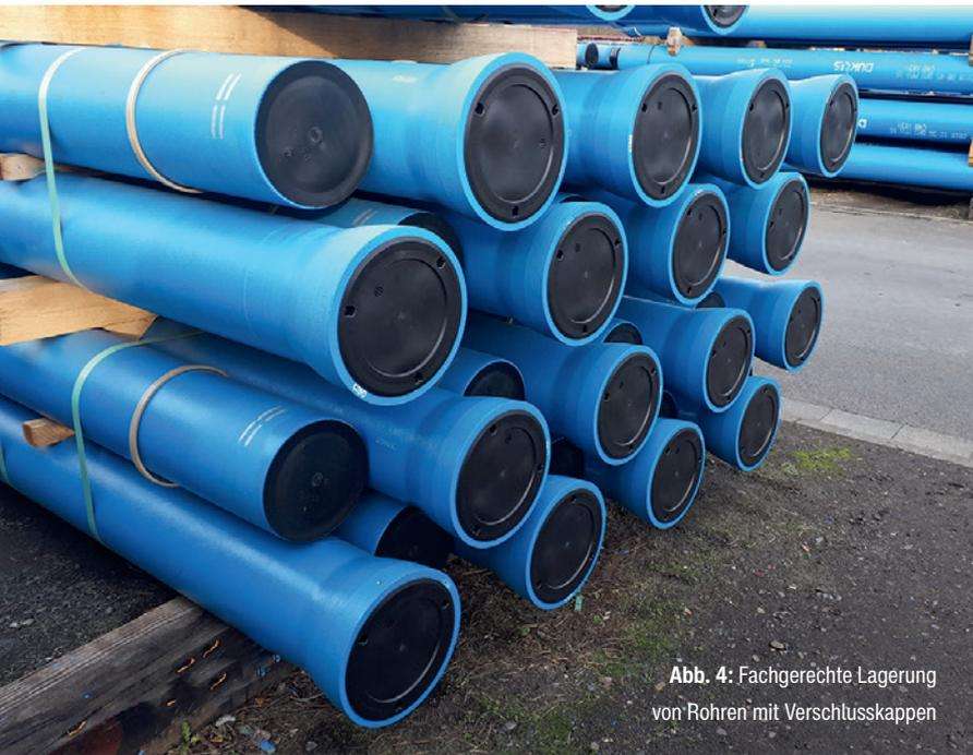
Abb. 4: Fachgerechte Lagerung von Rohren mit Verschlusskappen
