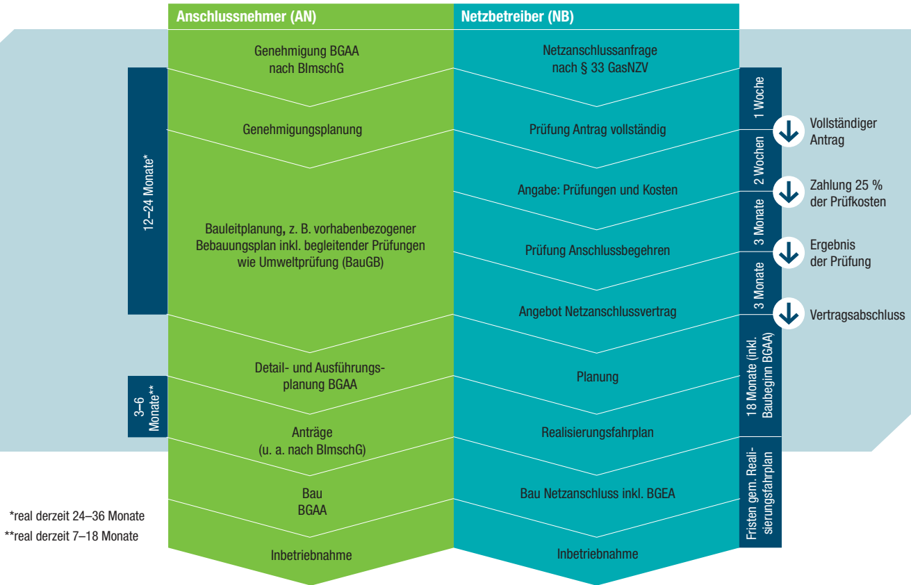
Abb. 2: Prozess der Einbindung von Biogasanlagen in das Gasnetz im Jahr 2024
