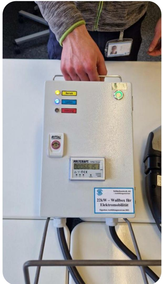
Abbildung 5: Gebaute Wallbox für Elektromobilität, © Schluchseewerk AG
