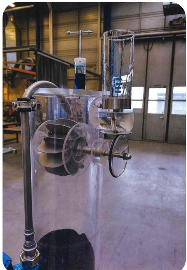
Abbildung 21: Schau- und Versuchsmodell: Filteranlage im Kleinformat, © Zweckverband Landeswasserversorgung
