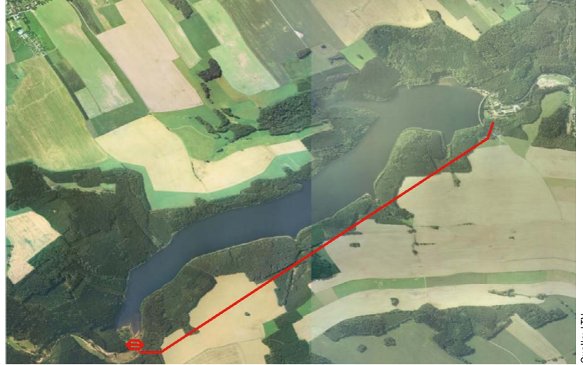
Abb. 2: Anordnung des Umgehungsstollens im Zuge der Instandsetzung der Talsperre Klingenberg
