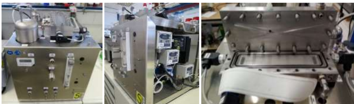
Foto Labormembranteststand (CUBE 80VA, Fa. Simatec)
