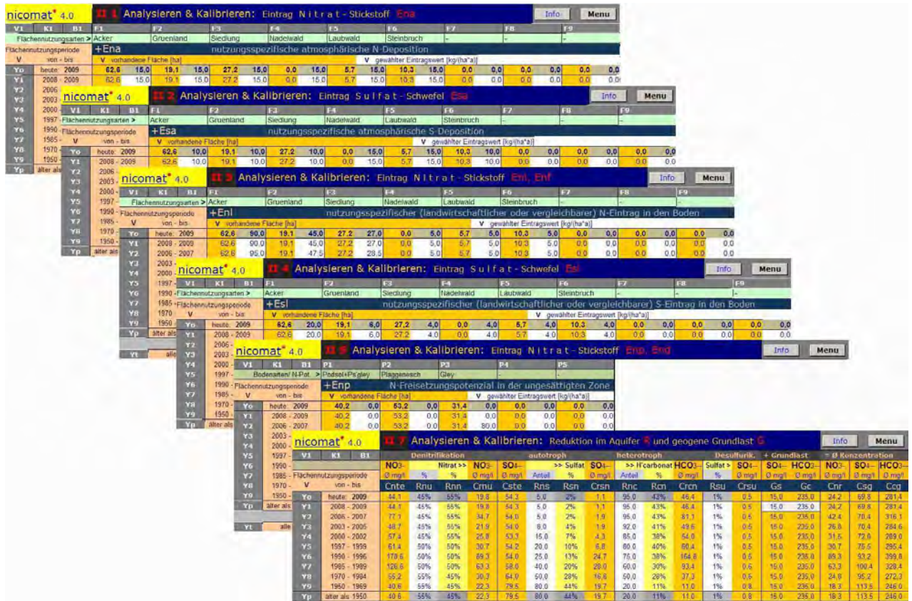
Abb. 5-7 Auswahl von Eingabeseiten im Nicomat-Programm im Modul „Analysieren und Kalibrieren“ zur Definition des zeitlich und örtlich diskretisierten Stoffeintrags (Fracht Stickstoff und Schwefel) und Stoffumsatzes (autolitho- und heterotrophe Denitrifikation); Eingabefelder sind weiß hinterlegt.
