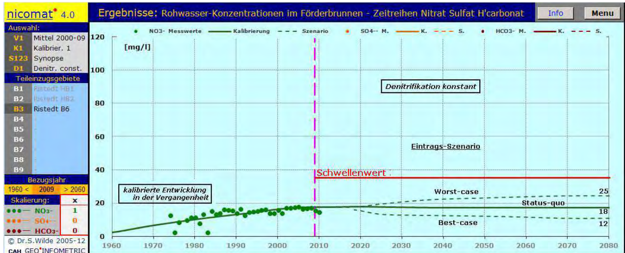
Abb. 8-7 Beispiel von Szenarienberechnungen (hier WGG Ristedt, Br. B6) unter der Prämisse „Denitrifikation konstant“ (Prognose mit Nitratabbau); dargestellt ist die Nitratkonzentrationsentwicklung der Eintrags-szenarien „Worst case“ und „Best case“ (gestrichelt) im Vergleich mit dem „Status quo“-Szenario.
